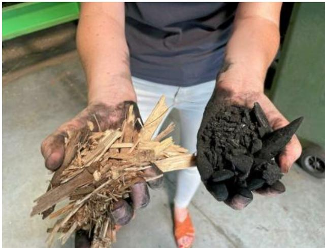
Le biochar, un charbon végétal issu de la pyrolyse de la biomasse, utilisable comme engrais ou comme additif pour le béton.
