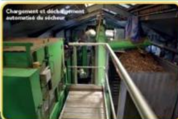
Sécheur autonome multiétages, multiproduits
